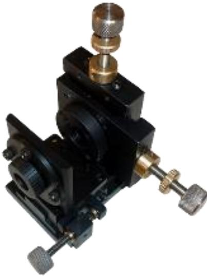
نگهدارنده فیلتر فضائی SFM003 از یک جابجاگر تک محور عدسی در راستای محور X برای تمرکز پرتوها و صفحه متحرک در راستای Y-Z برای کنترل مکان پین هول تشکیل شده است. با عبور دادن نور لیزر از میان عدسی و کانونی کردن آن بر روی پین هول مناسب، می توان نوسانات موجود در پروفایل شدت نور را از بین برد و در عین حال انتظار اتلاف توان بسیار کمی پس از این فرآیند را داشت.
